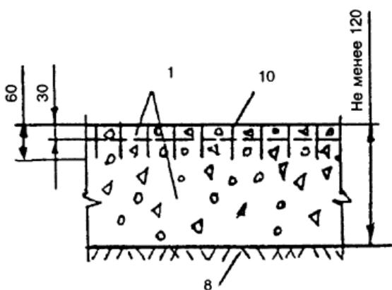
1 - покрытие из жаростойкого бетона;
